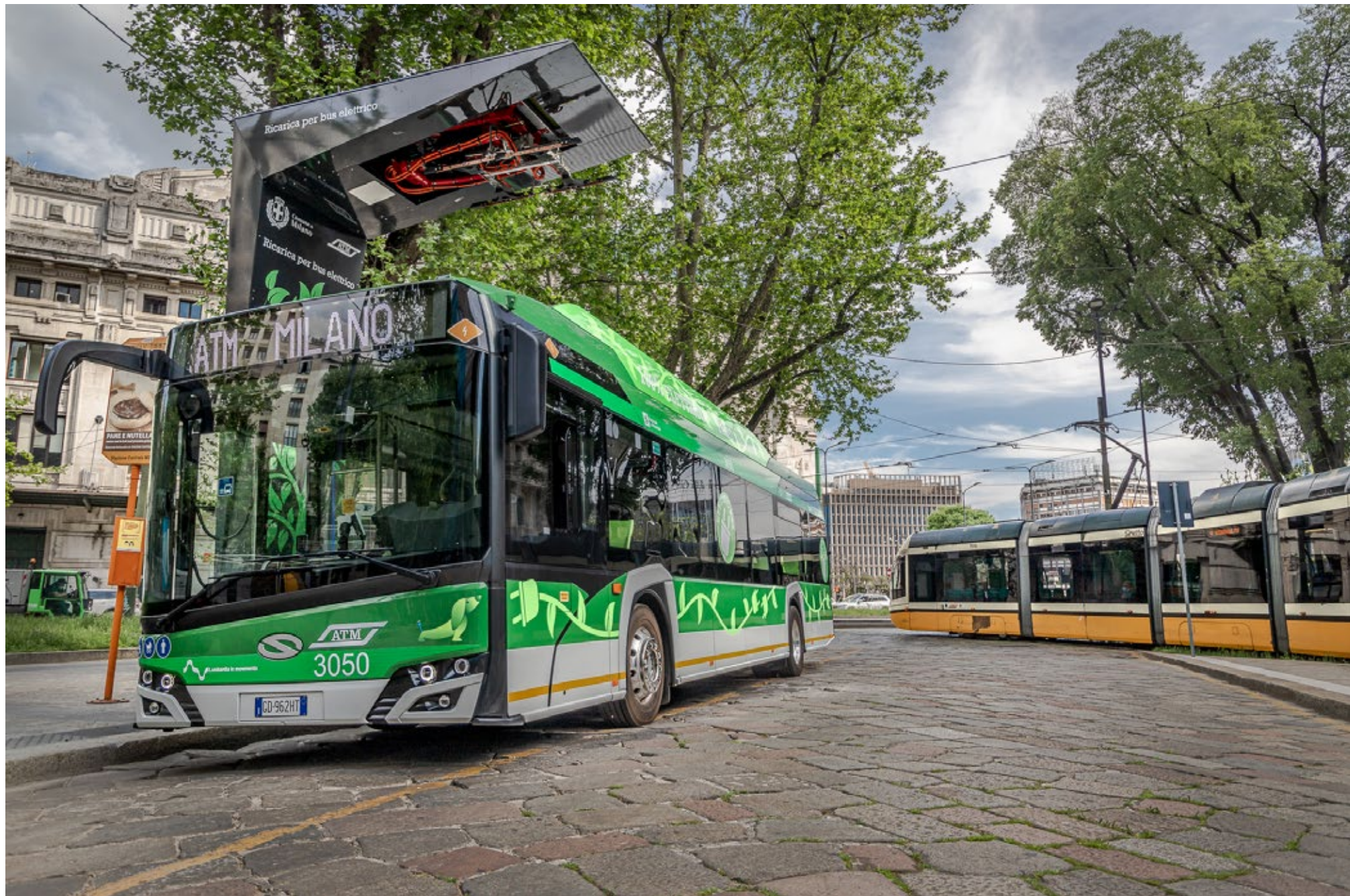
Ricarica rapida di un bus elettrico in piazza IV Novembre, stazione Centrale. Fast opportunity charging of an electric bus in piazza IV Novembre, Milano Centrale train station.
